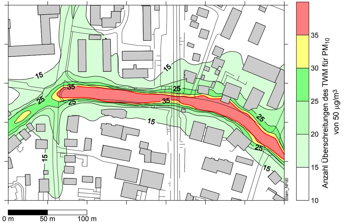
Abbildung 10.15: Nordportal – Anzahl Überschreitungen 2012 des Grenzwertes für den Tagesmittelwert der PM<sub>10</sub>-Belastung, 20% Portalabluft
