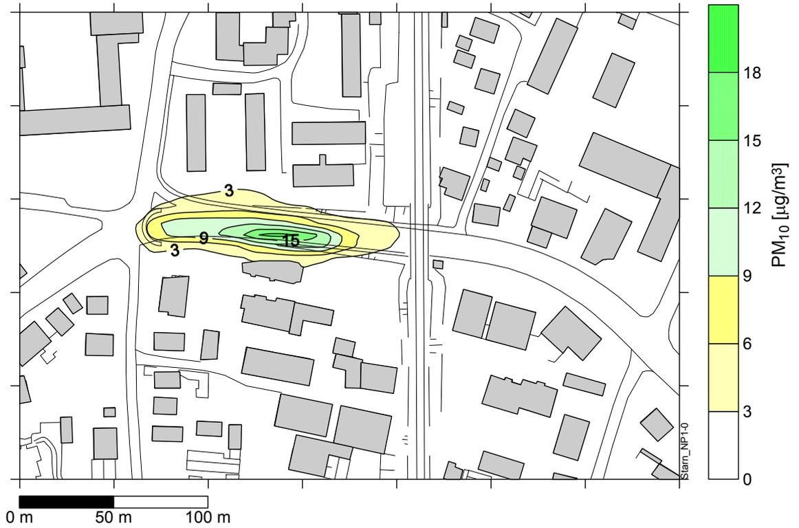
Abbildung 10.11: Nordportal – Minderung 2012 der PM10-Belastung durch Mittenabsaugung
