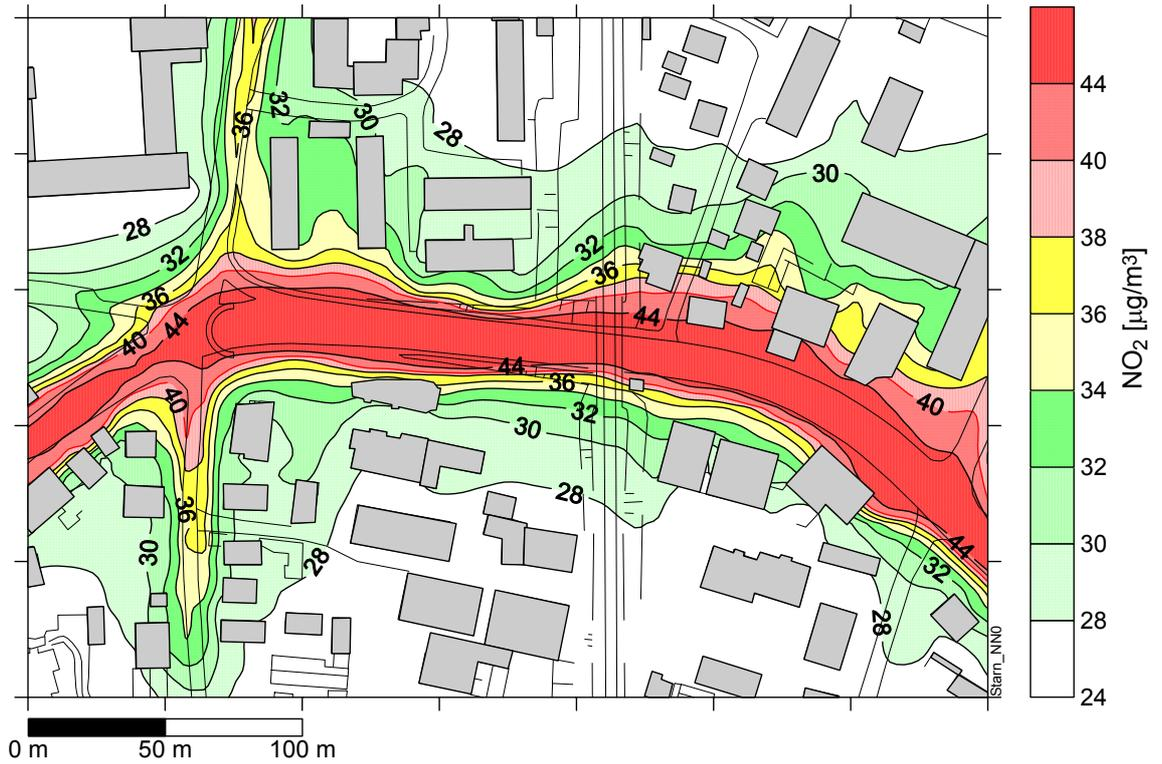
Abbildung 10.3: Nordportal – Jahresmittelwert 2012 der NO<sub>2</sub>-Belastung, 20% Portalabluft
